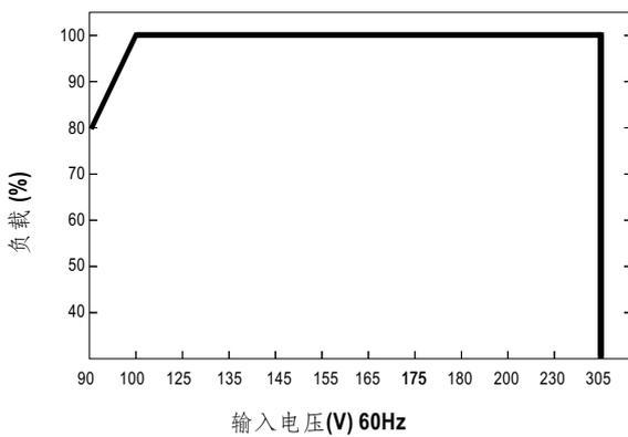
低输入电压情况下需减额输出
