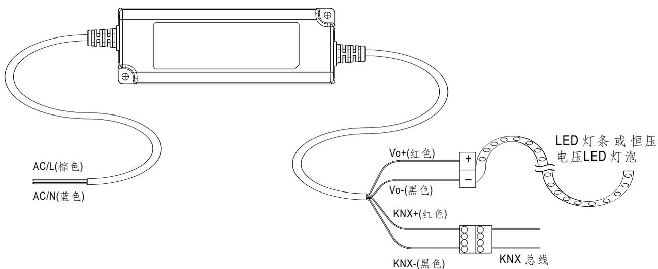
PWM KN系列无需连接市电即可寻找或编程
